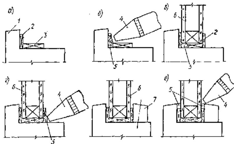
Рис. 8. Установка, крепление и уплотнение стеклопакета в переплете
