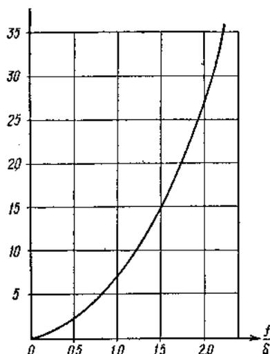
Рис. 3. График для определения отношения  $f/\delta$  и прогиба  $f$  наружного стекла стеклопакета
