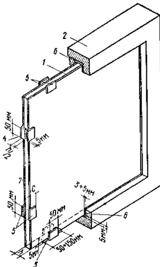
Рис. 5. Размещение прокладок при установке стеклопакета в переплет
