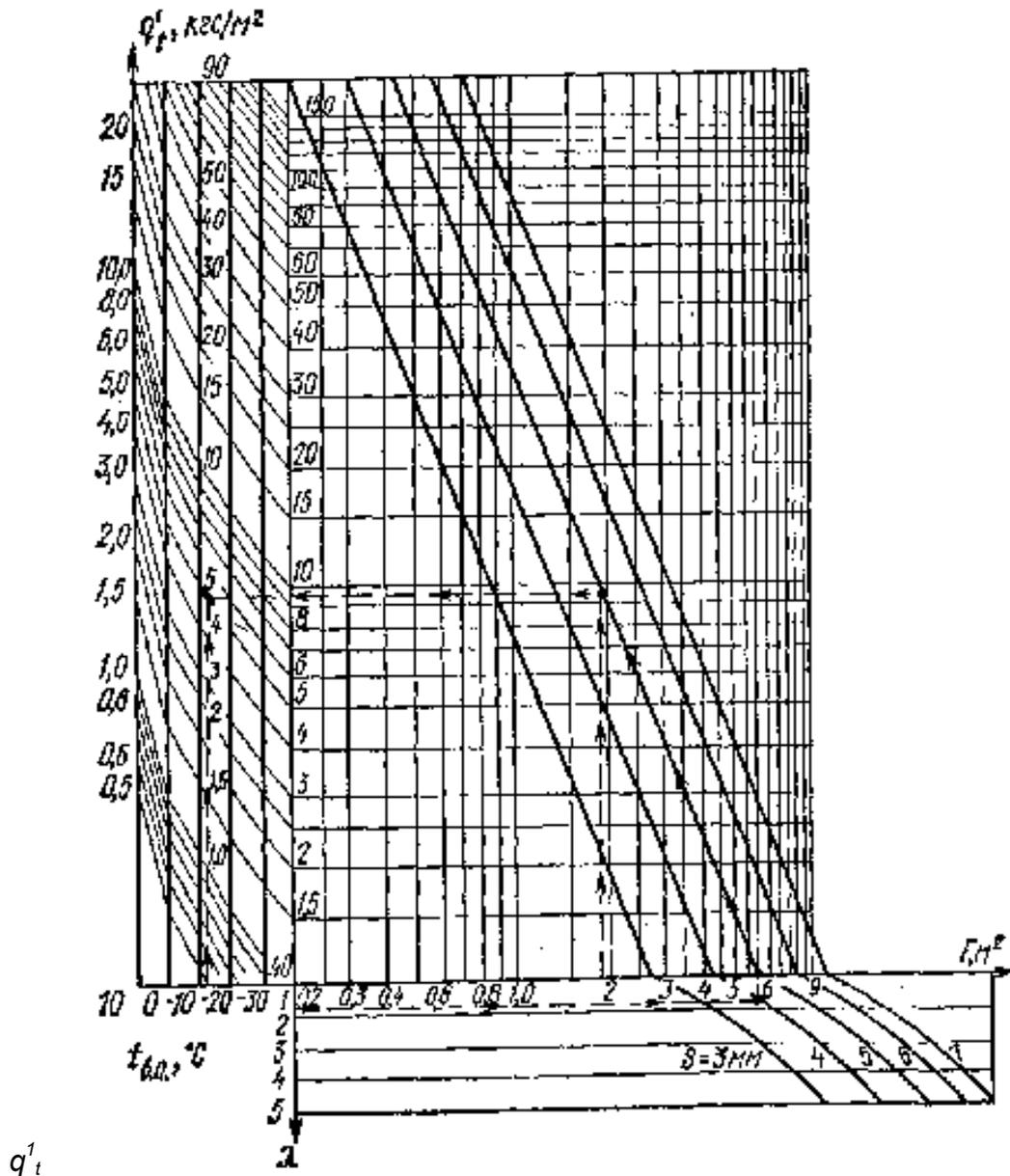
3.9 Расчетная нагрузка  $q_t$ , кгс/м<sup>2</sup>, от изменения температуры воздуха определяется по формуле
